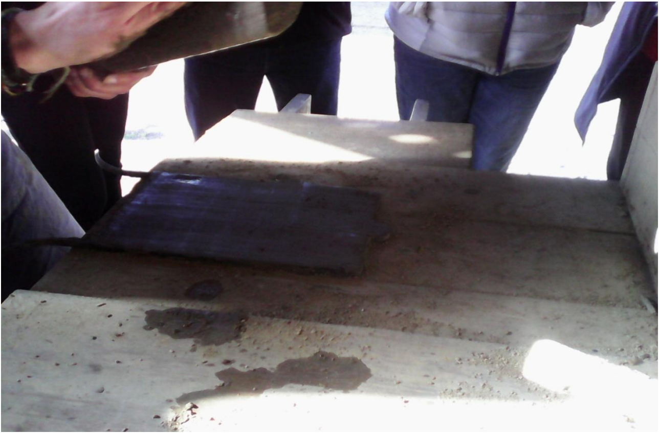
La tuile est terminée. Il reste à réaliser le crochet.
